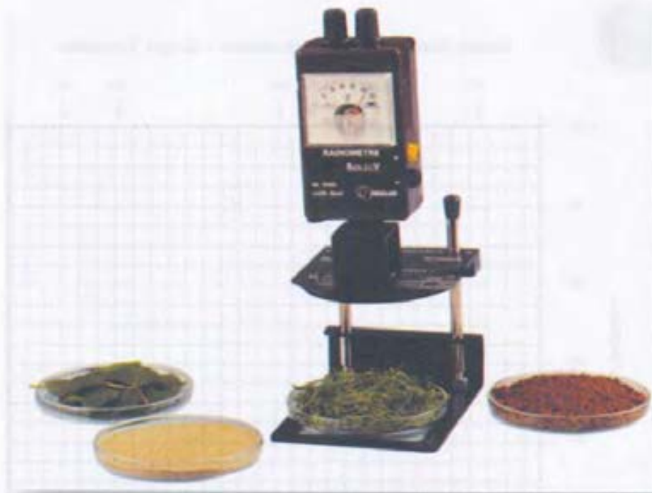
Figura 3. JEULIN Radiometre, Registro 555031.
