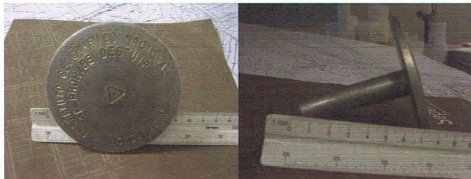
Figura 5.- Clavo de aluminio grabado prototipo del IP
