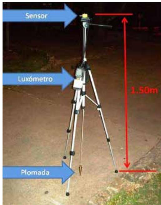
Figura 4. Equipo utilizado durante las mediciones de iluminación.
