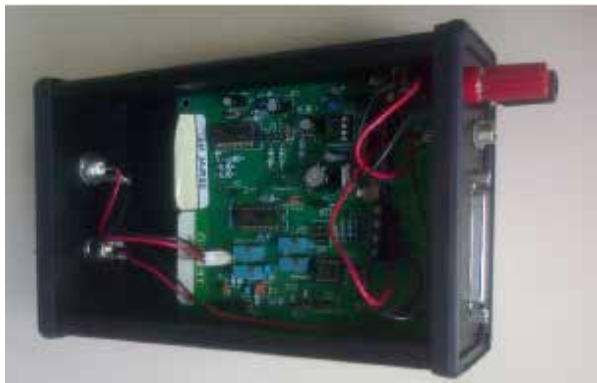
Figura 1. Receptor VLF UKRAA para la detección de Perturbaciones súbitas en la Ionosfera.
