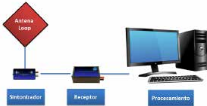
Figura 3. Diagrama de componentes del receptor VLF UKRAA
