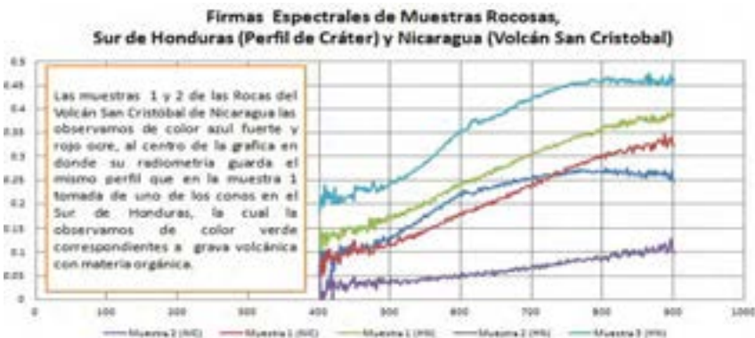
Figura 9. Firmas espectrales de los materiales rocosos del Volcán San Cristóbal (Nicaragua) y Las muestras de la zona identificada como cráter al sur de Honduras.
