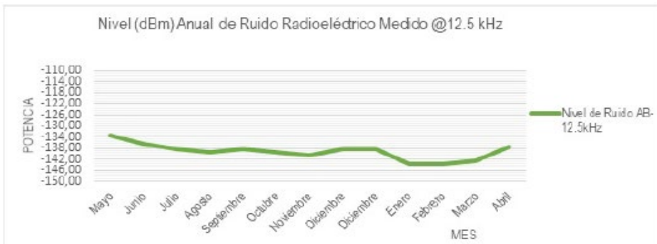
Figura 5. Intensidad de Campo del Ruido Radioeléctrico en 408MHz @ 12.5kHz de AB.
