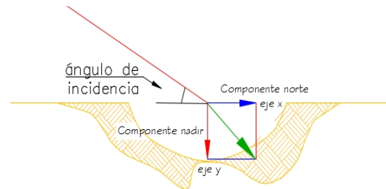
(b) Esquema que muestra la dirección de las componentes de la energía cinética total dividida en dos direcciones según el ángulo de incidencia.
