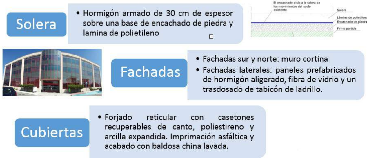
Figura 5: Características Constructivas de la Envolvente. Fuente: Planos constructivos del Edificio de Servicios
