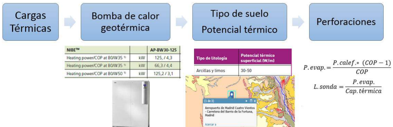
Figura 14: Climatización por Geotermia Fuente: Propia.
